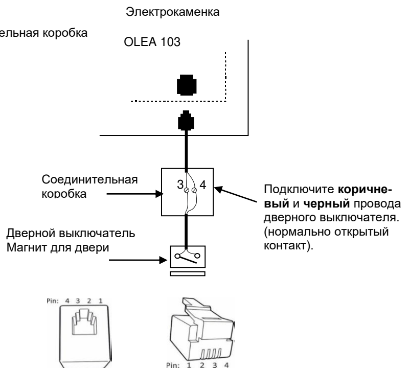
Рис 7. Расположение выводов разъема RJ10 печатной платы.
